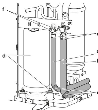
5 Si l'unité extérieure est installée au-dessus de l'unité intérieure, couvrez les vannes d'arrêt (f, voir ci-dessus) avec le matériau d'étanchéité pour éviter l'eau condensée sur les vannes d'arrêt se déplace vers l'unité intérieure.
