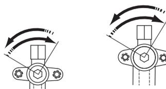
Dans le sens inverse des aiguilles d'une montre pour ouvrir.
