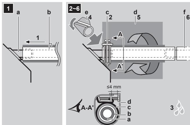
a Raccord du raccord de tuyau (fixé à l'unité)
