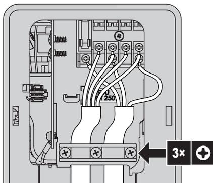
5 Serrez bien les vis des bornes. Nous recommandons d'utiliser un tournevis cruciforme.
