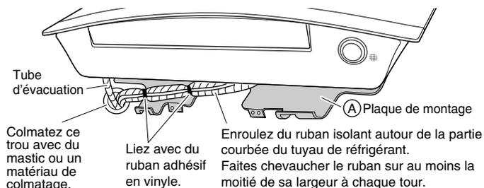
9) Tout en prenant soin que le câble connectant les unités ne se prenne pas dans l'unité intérieure, appuyez avec les deux mains sur le bord inférieur de l'unité intérieure jusqu'à ce qu'elle soit accrochée fermement dans les crochets de la plaque de montage. Fixez l'unité intérieure sur la plaque de montage avec des vis de fixation de l'unité intérieure (M4 x 12L).
