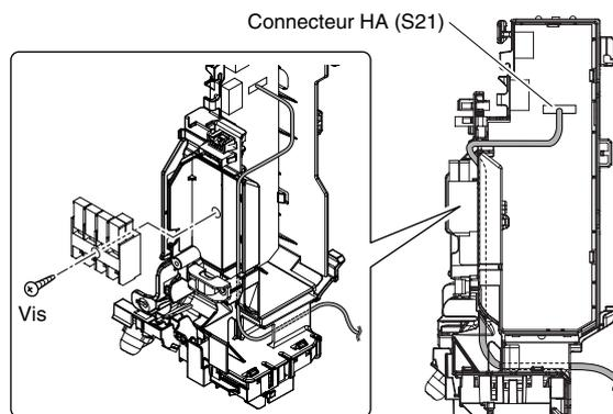
• **Méthodes de fixation des couvercles métalliques du câblage électrique**
