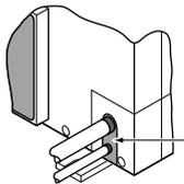
1 Mastic et matériel isolant (produit localement)
