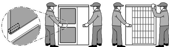
Placez les mains sur le coin au lieu de tenir l'alimentation d'aspiration à l'intérieur du boîtier sinon le boîtier pourrait être déformé.
