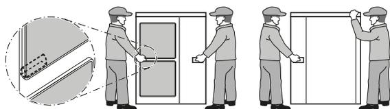
Placez les mains sur le coin au lieu de tenir l'alimentation d'aspiration à l'intérieur du boîtier sin le boîtier pourrait se déformer.
