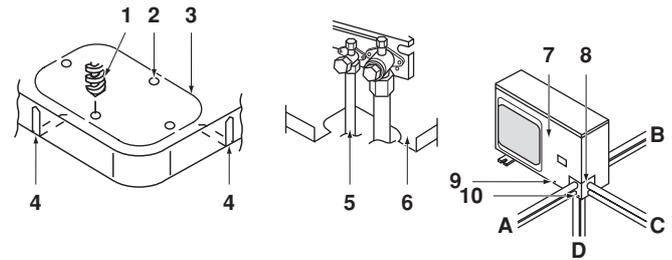
Figure - Tuyauteries non-fournies dans quatre directions
