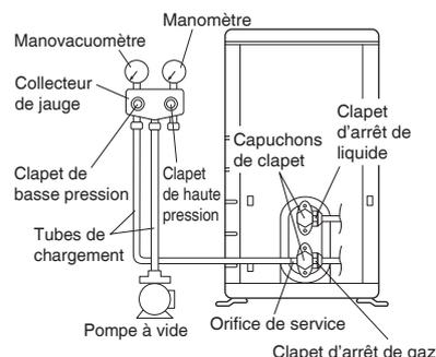
1) Connectez le côté saillant du tube de charge (provenant du collecteur de jauge) pour fermer l'orifice de service du clapet d'arrêt de gaz.
