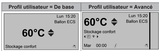
Pour lire et régler la température de réchauffage souhaitée (en mode de réchauffage et mode programmé)
