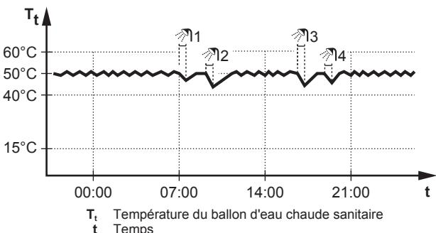
T<sub>t</sub> Température du ballon d'eau chaude sanitaire
